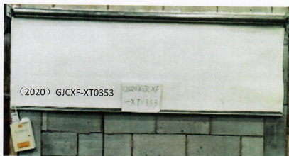
照片1 耐高温性能试验前试件情况
